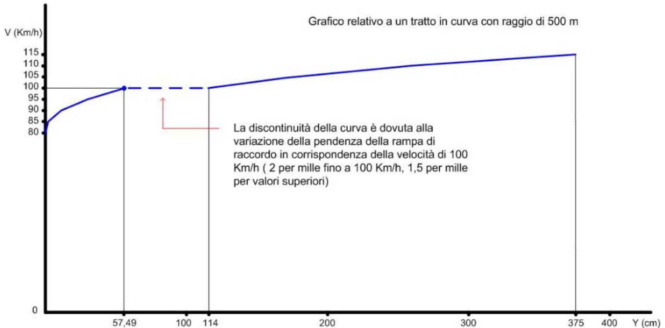
Figura 1 -Rappresentazione grafica della velocità che si vuole ottenere in funzione dello spostamento Y del binario, all'estremità del raccordo parabolico (Si tenga sempre presente che gli aumenti di velocità non sono direttamente determinati dagli spostamenti del binario, bensì dalla connessa sopraelevazione della rotaia esterna).
